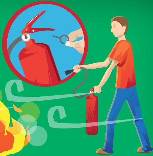
5. Mantén el extintor en posición vertical, aprieta la manilla y mueve la boquilla de un lado al otro y hacia la base del fuego para extinguirlo.
