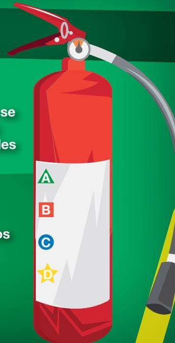
3. Hala el anillo de seguridad en la parte de arriba del extintor.
